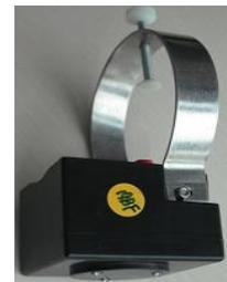
O GWFOL2-E16 pode monitorar as mudanças da corrente de seqüência-zero e capturar rapidamente a primeira corrente de seqüência-zero de meia-onda para detecção de falta à terra. Depois que a falha de terra ocorrer, ela piscará três LEDs e enviará o sinalizador de ação para o DCU imediatamente. Além disso, o GWFOL2-E16 pode monitorar a corrente de seqüência-zero em regime permanente, a corrente
