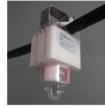
Avec une pièce métallique conductrice et un fil interne, le GWFOL2-A16 peut surveiller les changements de la tension de terre monophasée de la ligne aérienne et capturer rapidement le courant de terre transitoire monophasé pour la détection de défaut à la terre. Après un court-circuit ou un défaut à la terre, trois voyants clignotent, un
